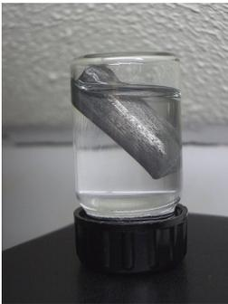
Bild 1: Lithium in einem mit Benzin gefülltem verschlossenem Glas
