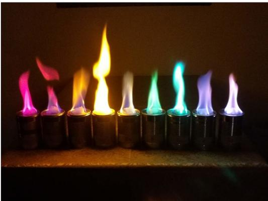
Bild 2: Flammenfärbung (von links nach rechts: 1. Flamme: Lithiumchlorid; 4. Flamme: Natriumchlorid; 8. Flamme: Cäsiumchlorid; 9. Flamme: Kaliumchlorid)
